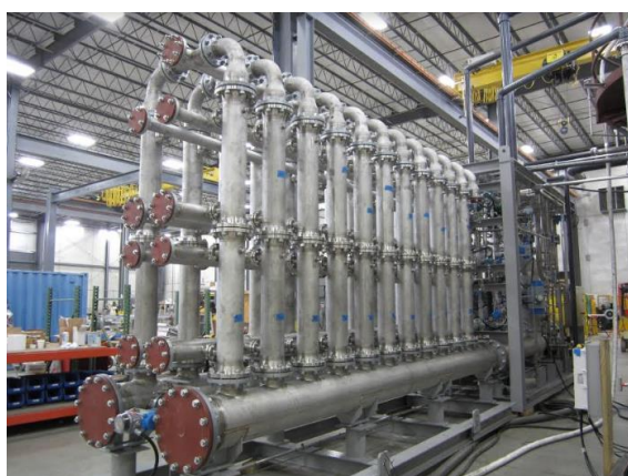
Système d'équipement de filtration CeraMem. Débit d'écoulement de 600gpm (135m 3 /heure)
